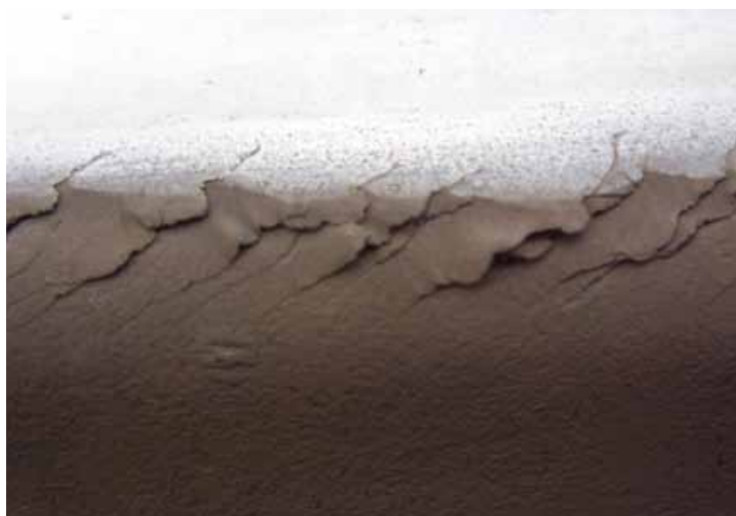
10. ábra. Gördülőfáradásos sínhiba – „nyelvképződés”
