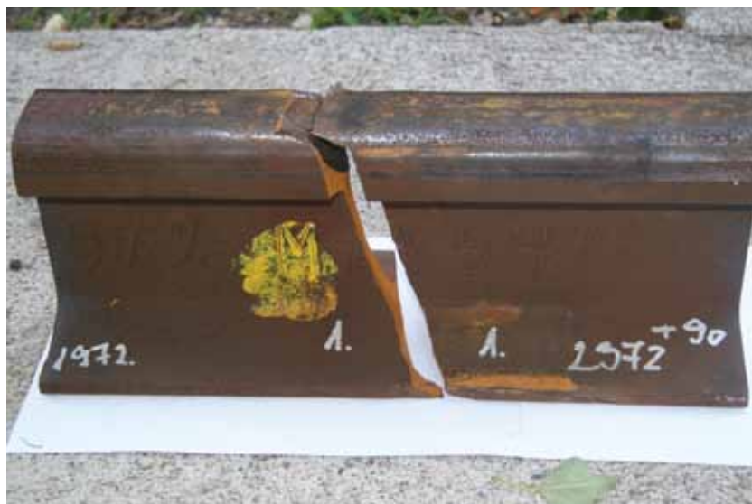
1. ábra. Lapulásos hibából kiinduló sintörés, Debrecen
