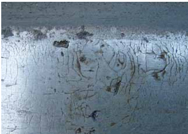
11. ábra. Kialakuló kezdeti repedésfészkek (Belgrospi), Budaörs–Biatorbágy, a 159–160 szelvények között
