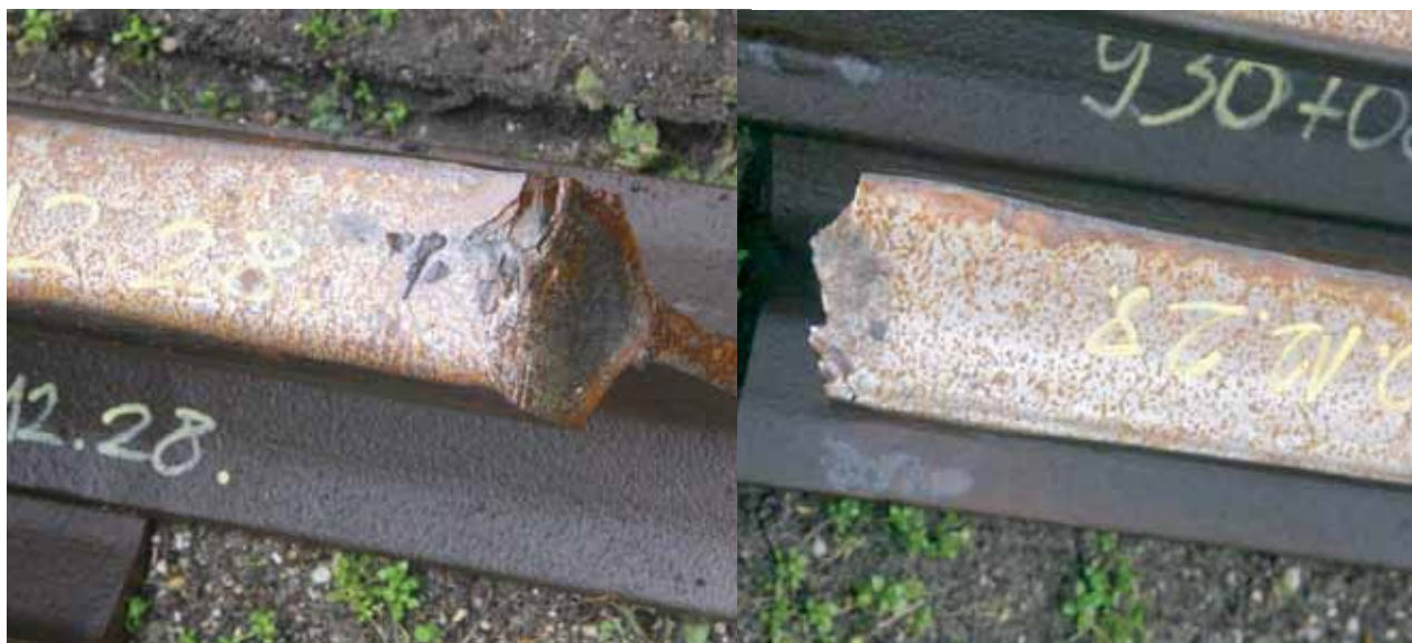
6. ábra. Lapulós sínhiba a Vámosgyörk–Ludas 930+08 szelvényben a bal vágány jobb sínszála
