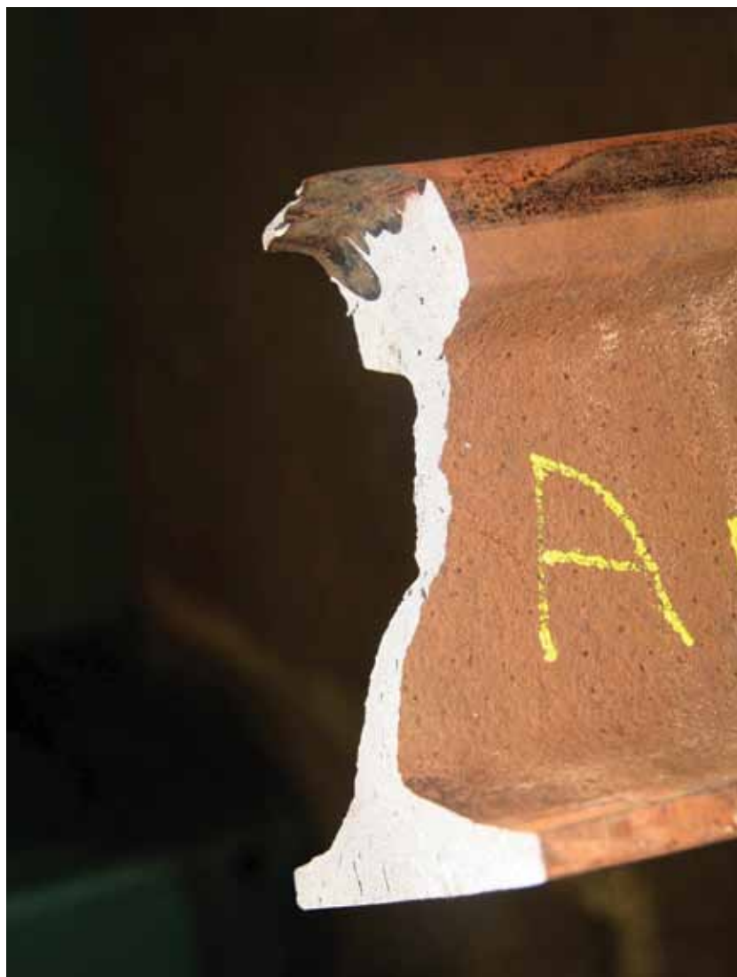
3. ábra. Lapulásos sínhiba törési képe, Debrecen
