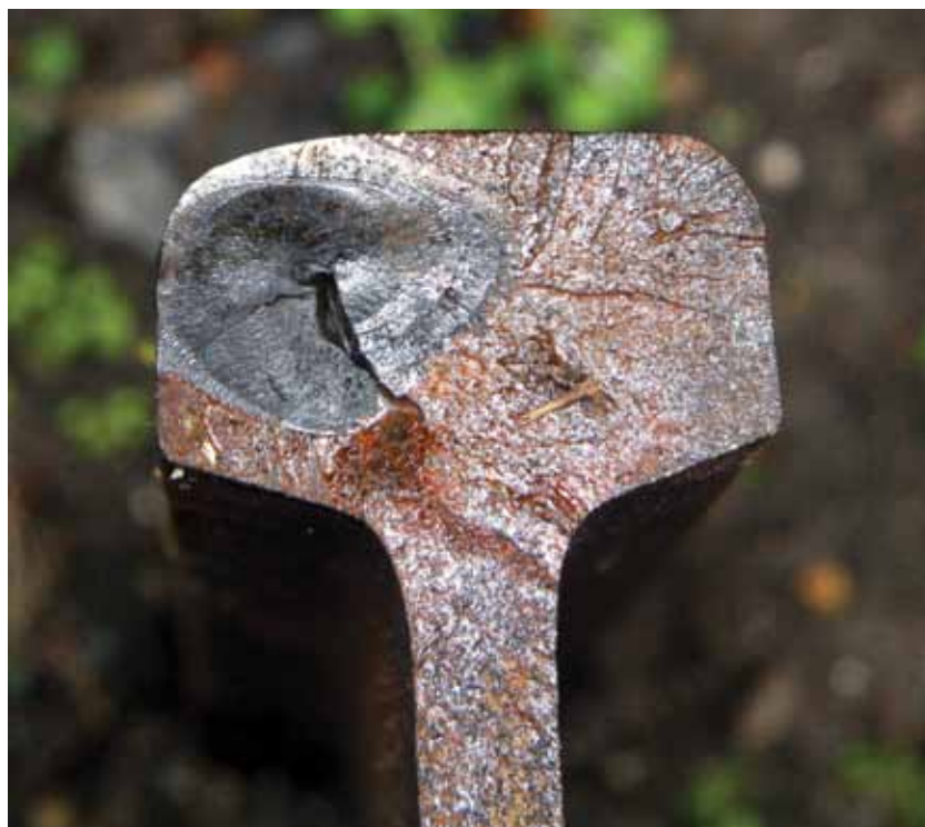
8. ábra. „Vese” alakú sínhiba Nagyút-Kál-Kápolna 1113/14 szelvényében.
