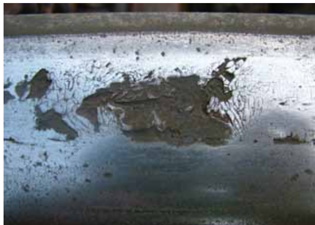
12. ábra. Kialakult repedésfészkek, Budaörs–Biatorbágy, a 159–160 szelvények között
