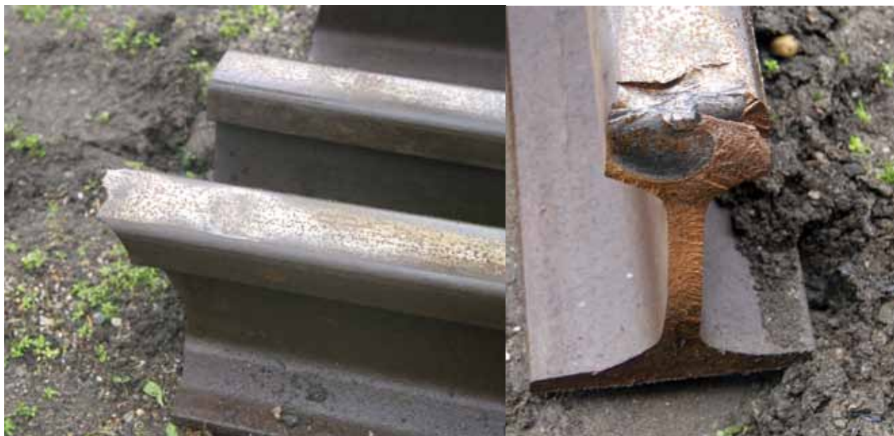
2. ábra. Lapulás típusú hibák megjelenése a felületen és a keletkezett törésfelülete, Vác
