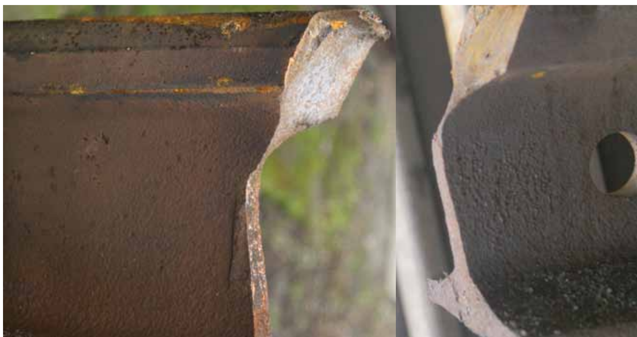
7. ábra. Lapulós sínhiba Ludas-Nagyút 1012/13 szelvényben.
