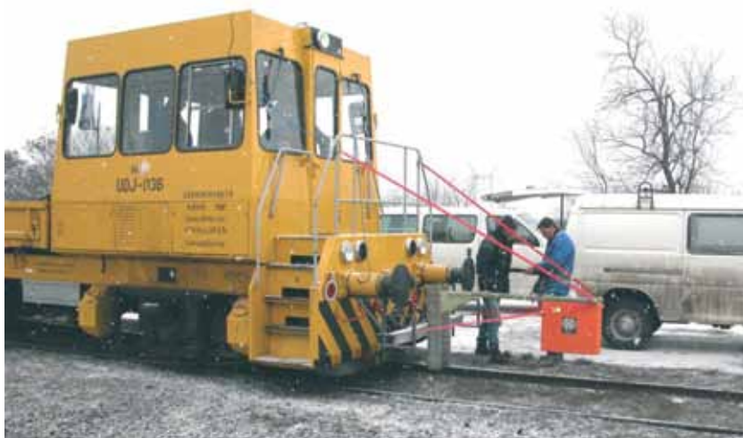
8. ábra. Radarantenna felszerelése az UDJ-re
