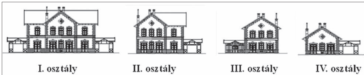
5. ábra. Típus felvételi épületek egy csoportjának homlokzati rajzai
