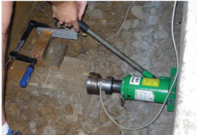
2. ábra. A vasbeton aljas felépítményen végzett oldalirányú erő vizsgálata
