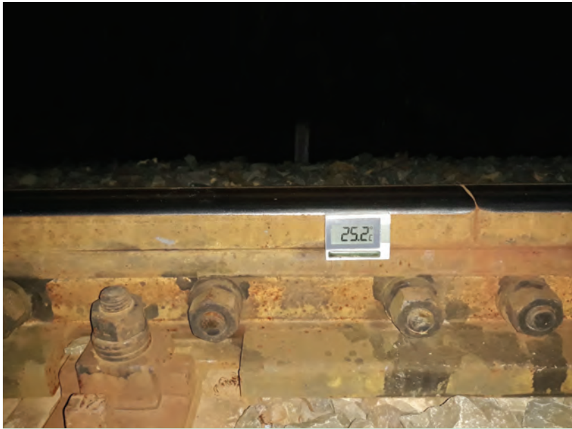
7. ábra. Sínhőmérséklet és illesztési hézag az 50-es vasútvonal 493+00 hm szelvényében
