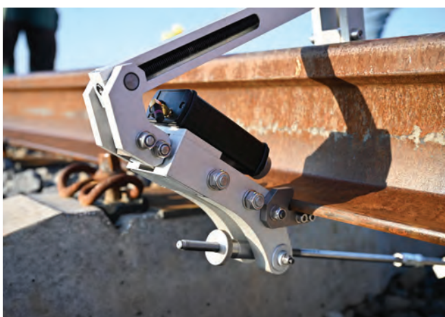
8. ábra. SidePull Light integrált húzó- mérő egysége
