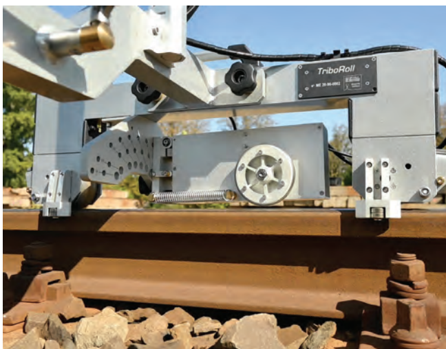
9. ábra. A TriboRoll súrlódási tényezőmérő készülék
