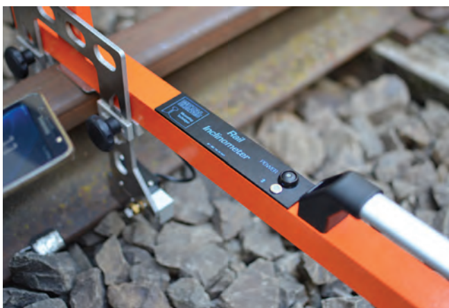
7. ábra. Rail Inclinometer síndőlésmérő készülék
