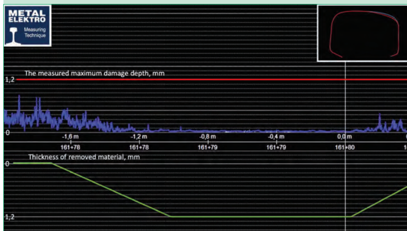
6. ábra. Leköszörüléssel meghatározott károsodási mélység és GF-04 mérési eredmény összehasonlítása a köszörülés előtt és azt követően
