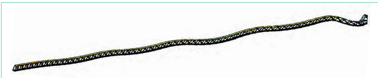
35. ábra. Számított függőleges hajlító lengésalak – 2,09 Hz
