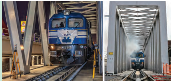
4. ábra. Statikus és dinamikus próbatерhelés (Fotó: Oravecz I)
