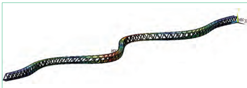
33. ábra. Számított keresztirányú hajlító lengésalak – 1,50 Hz
