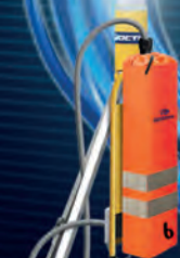
NOCTURNA MUNKATERÜLET VILÁGÍTÁS 5 FÉNYFORRÁS - 6 ÓRA ÜZEMIDŐ TELJES TERHELÉSSEL
