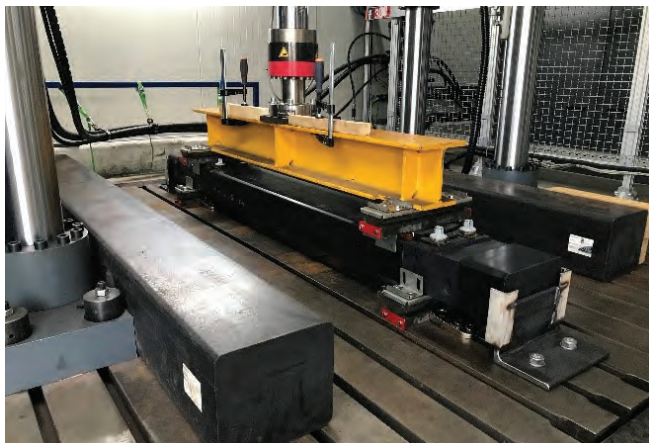
4. ábra. Hidraulikus teherbírás- vizsgálat alátétlemezen
