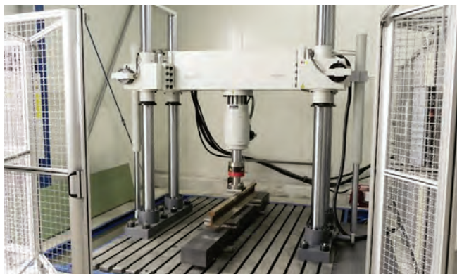
5. ábra. Hidraulikus nyomáspróba
