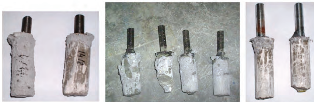
14. ábra. Lehorgony- zöcsavarok kiszakítás után
