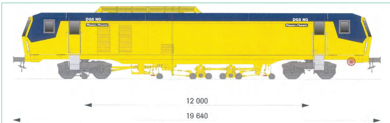
5. ábra. Plasser & Theurer DGS NG vágánystabilizátor jellemző méretei
