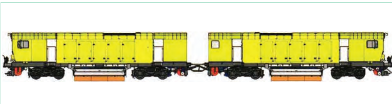
7. ábra. Harsco RGH 20 C2 vágányköszörű gép jellegrajza
