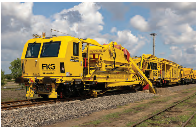
2. ábra. Plasser & Theurer RM 85-750 UHR típusú nagy teljesítményű ágyazatrostáló gép az MFS-egységekkel
