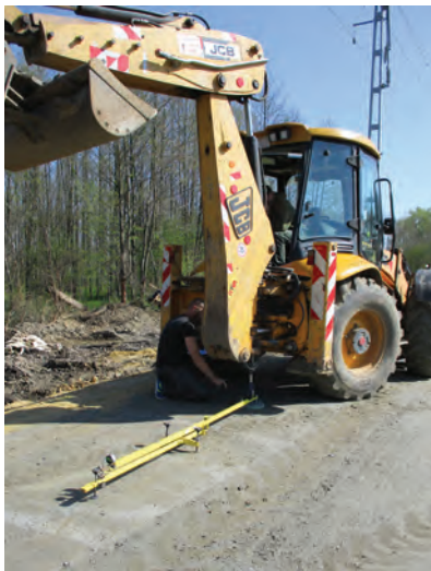
4. ábra. CKT-teherbírás mérése 2021. április 23-án a Somogyszob felőli oldalon. (Fotó: Giczi Katalin)
