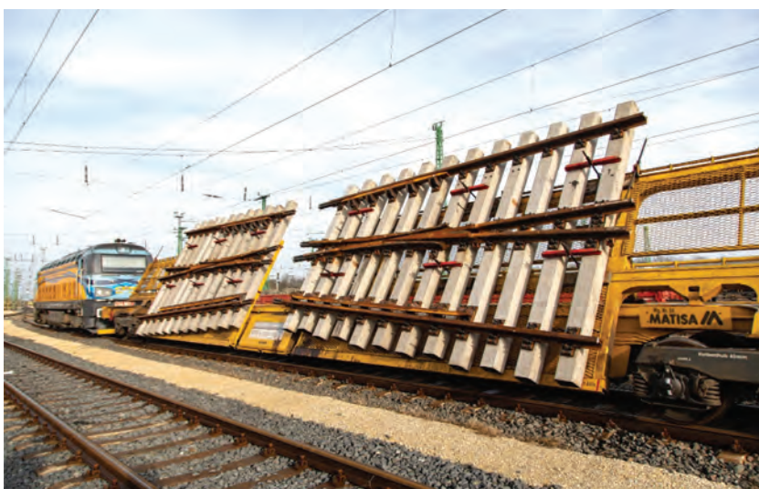
11. ábra. Előszertelt kitérő szállítása JIT-módon, ferde szállítókocsival
