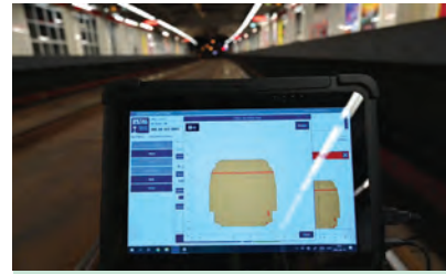
6. ábra. „Av” jelű vasúti űrszelvényre értékelt mérési eredmény metróban
