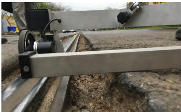
1. ábra. A közúti vasúti úrszelvény alsó részébe benyúló pályaburkolatok
