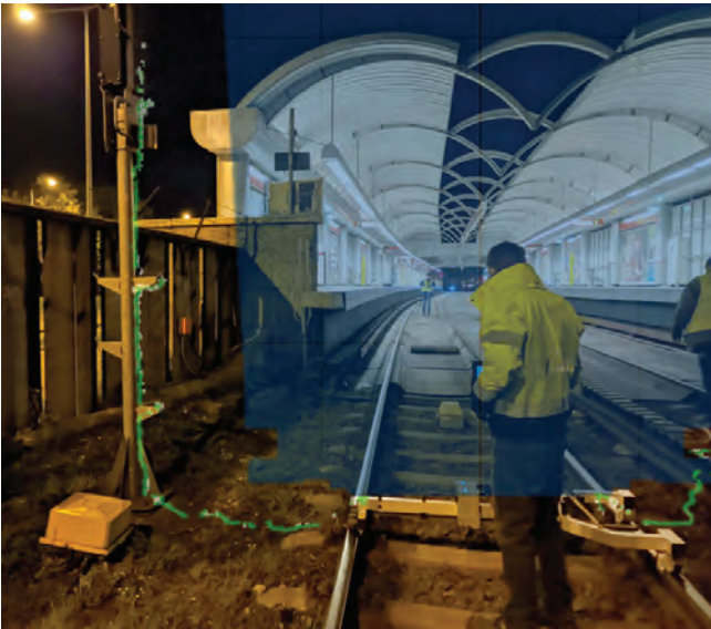
5. ábra. A mérési elv illusztrációja, az ábrán a felvett mérési pontok rajzolatát látjuk a valós tárgyakra vetítve (zölddel), illetve a metróban alkalmazott űrszelvény területét (kékkel)
