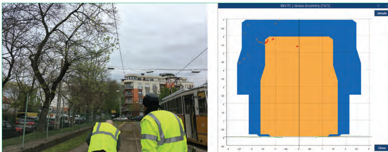
2. ábra. Az űrszelvény felső részébe nyúló, a munkavezeték megközelítő növényzet fényképe és mérési eredménye, a BKV vegetációs megfigyelési határ tervezetének (késsel) és a vonatkozó űrszelvény (sárgával) körvonalának ábrázolásával
