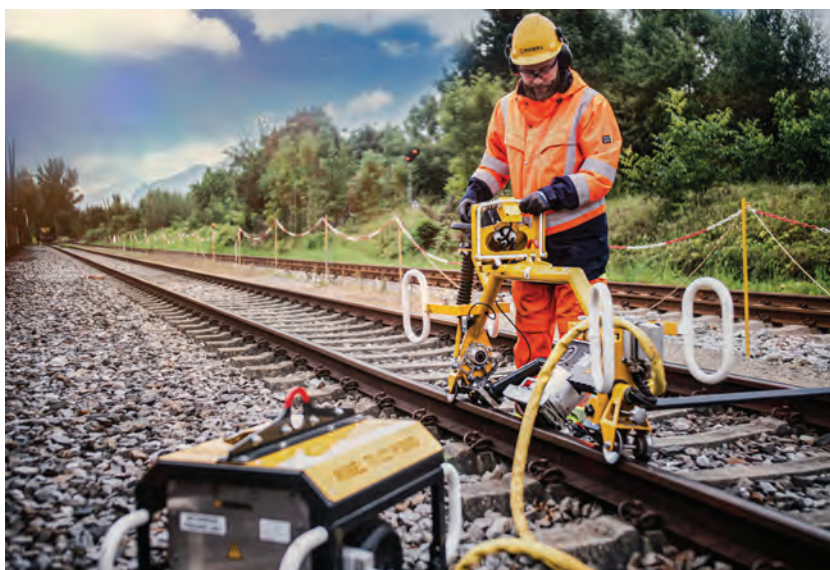
3. ábra. A hibrid meghajtású 13.49-es sínfejköszörű könnyű, gyors és pontos
