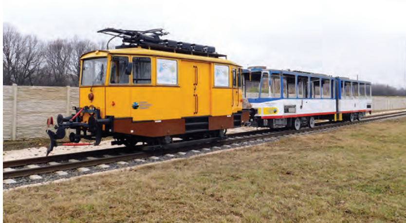
13. ábra. Az SZKT két üzemmódú M3 pályaszámú mozdonya munka közben. (Fotó: Nagy Mihály)
