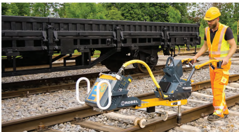
4. ábra. Elektromos csavarozógép 30,76 E 3 2300 Wh-s akkumulátorral, amellyel akár 4000 darab csavart lehet be- vagy kihajtani egy akkumulátortöltéssel
