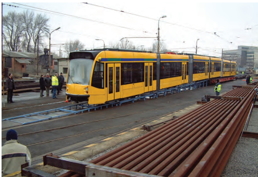
9. ábra. A Ferencváros kocsiszínbe érkező Combino pályára tétele a vasúti szállító járműről. (Fotó: Ferencz Tamás)
