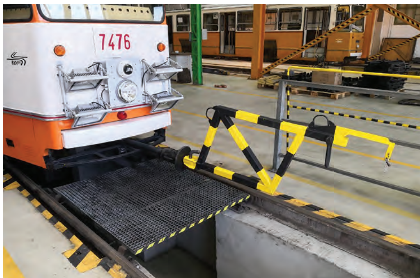
4. ábra. A mérővillamoshoz egyedileg gyártott vonórúd. (Fotó: Buday Péter)
