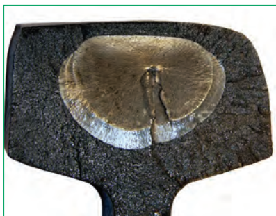
7. ábra. UH vizsgálattal kimutatott vese típusú sínhiba
