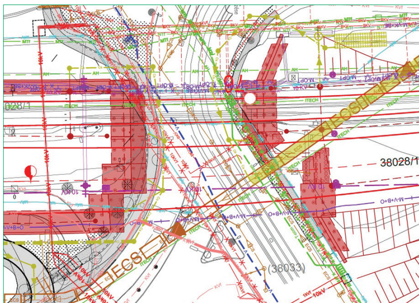
2. ábra. Közműkiváltások a Gubacsi úton. (Forrás: Kontúr Csoport Kft.)
