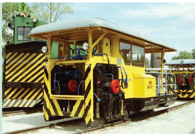
16. ábra. A MÁV „Buda” AVG 01. pályaszámú aláverő gépe. (Fotó: Németh Andor)
