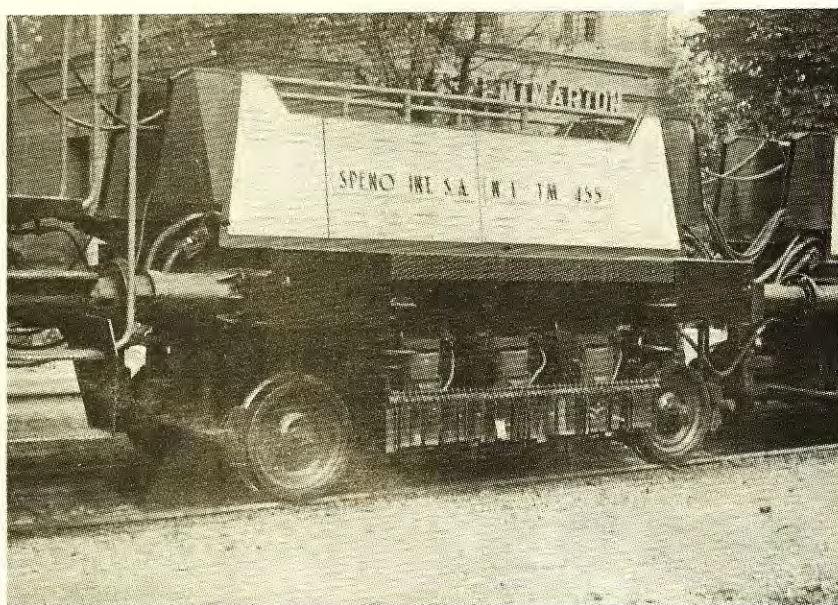
2.b.ábra 2 x 3 db csiszolótárcsás munkagép egység
