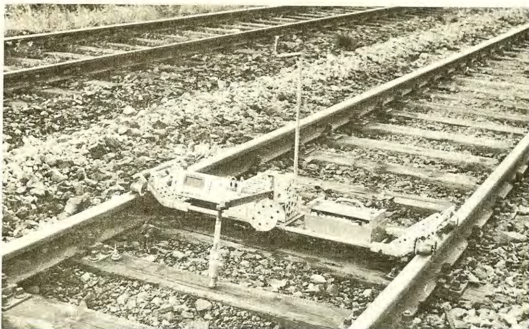
4. ábra: Az aljak csillapított rezgése dekrementumának mérésére szolgáló műszer-kocsi a komplett berendezéssel
