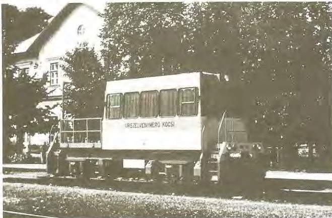
15. ábra FM 005 sz. Űrszelvénymérő kocsi
