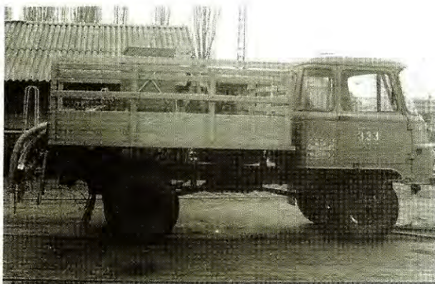
2. ábra A granulátumszóró teherkocsra szerelt változata
