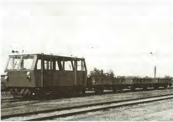
2. ábra PROFIL 600 típ. ágyazatredezógép
