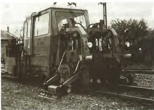
3. ábra HIDRO-VIBRO 600 típ. aljköztömörítógép
