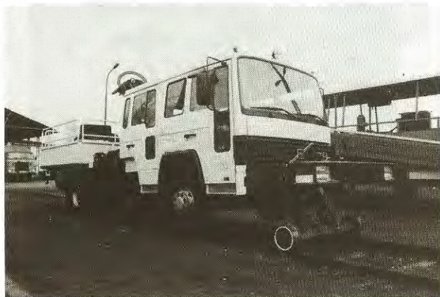
8. ábra KVSJ típusú közúti-vasúti szerelőkosaras darus jármű
