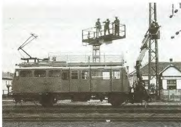
9. ábra OTW 100 K típusú felsővezeték-szerelő jármű
