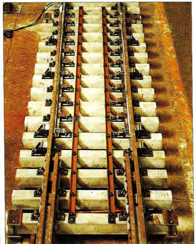
12. ábra. 200 mm nyitású síndilatációs készülék
