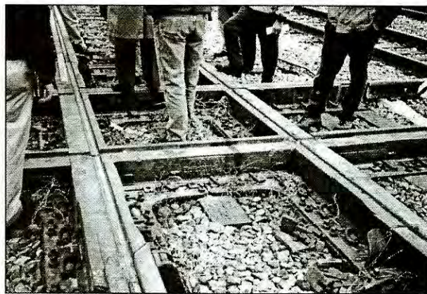
16. ábra. Különböző ötvözetek kopási és fáradási vizsgálata keresztezésekben a Transportation Technology Center területén
