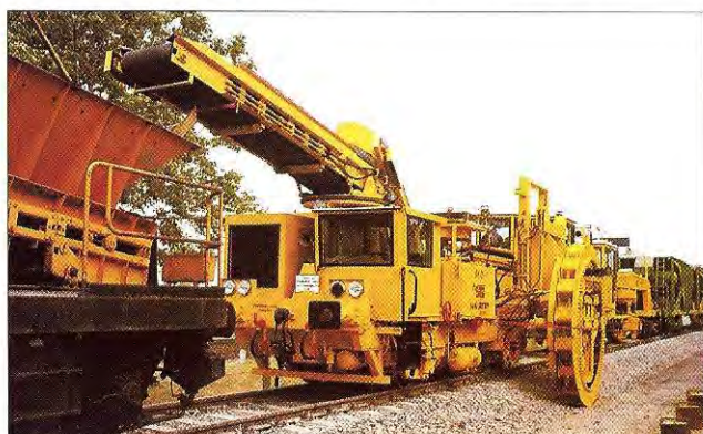
8. kép. A magyar–amerikai kooperációban gyártott lokális hibaelhárító géplánc
