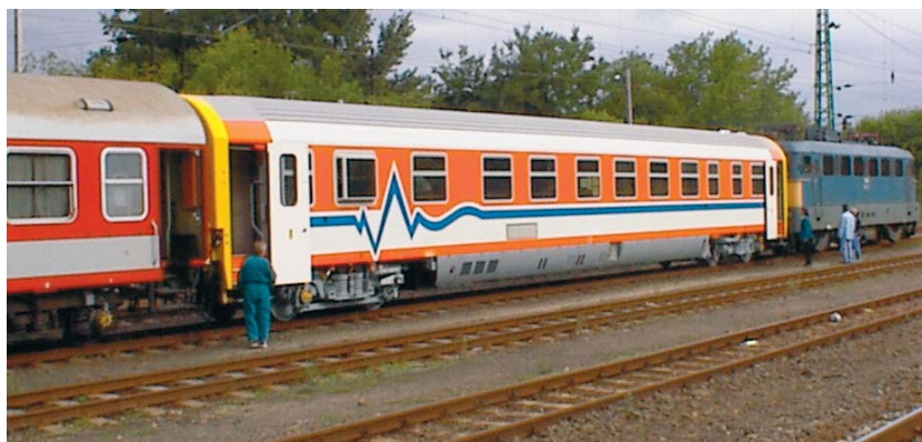
3. ábra – Az FMK-007 felépítményvizsgáló mérőkocsi
