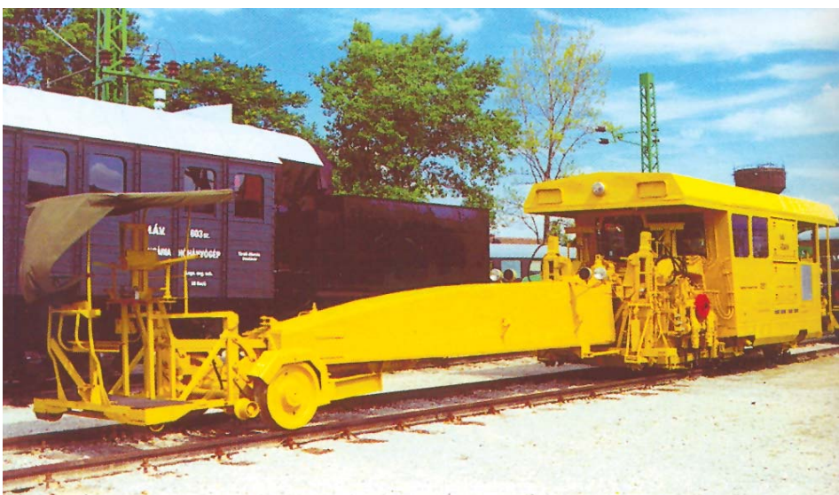
18. ábra – Attila szintkiemelő aláverő gép
