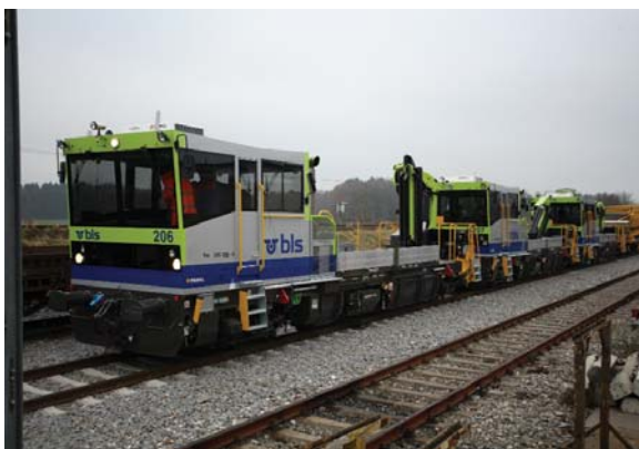
3. ábra. Többszörös vontatási feladat az 54.22 típusú vágánygépjárművel
