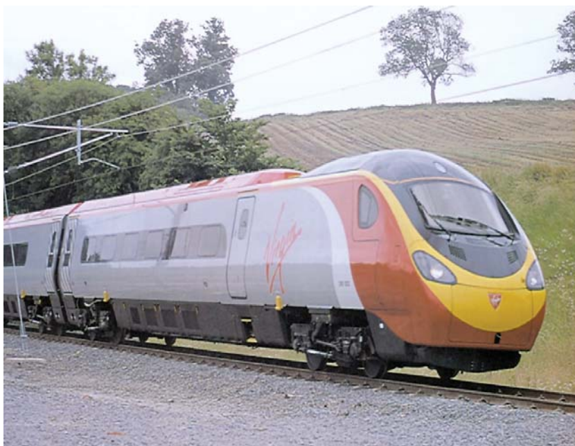
1. kép. A Virgin Trains „Pendolino” vonatait 225 km/h sebességre tervezték
