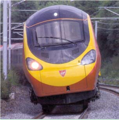
2. kép. A Pendolino a billenőszekrényes megoldásnak köszönhetően 25 százalékkal gyorsabban haladhat a pálya kiépítési sebességéhez képest
