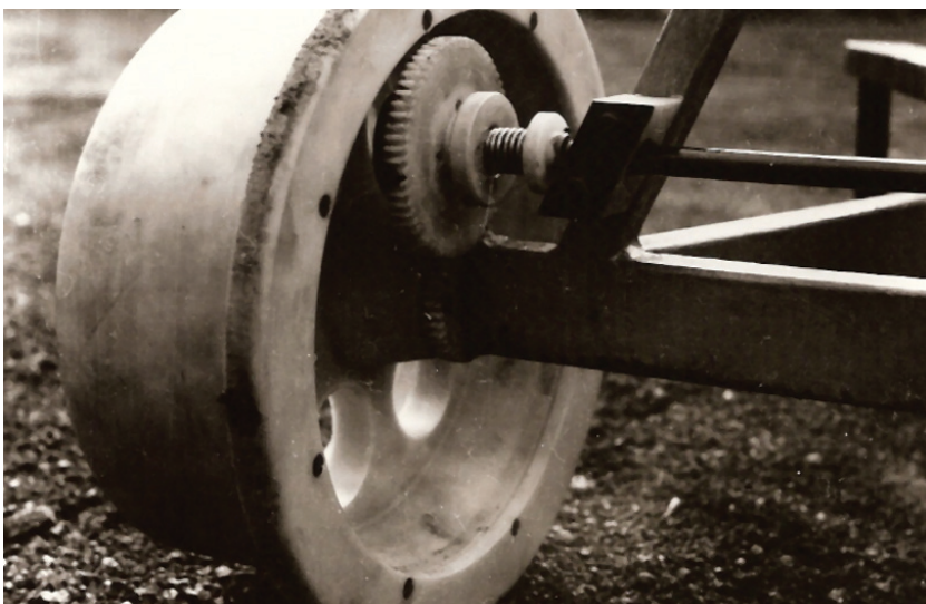
5. ábra. A műanyag kerék az útarányos hajtást biztosító fogaskerékpárral
