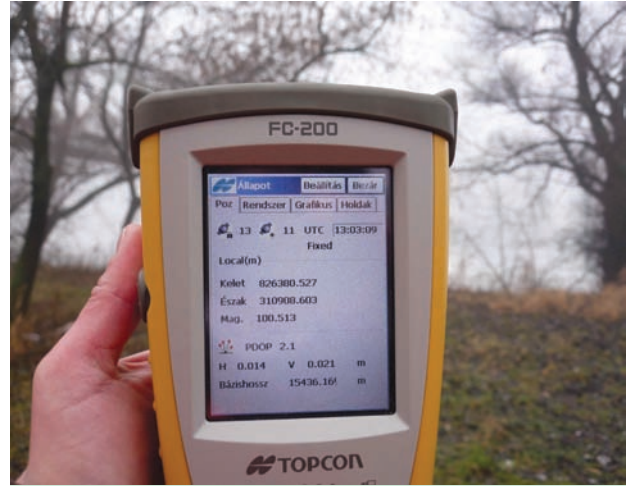
9. ábra. Topcon FC 200 terepi vezérlő pozícióra vonatkozó képernyője
