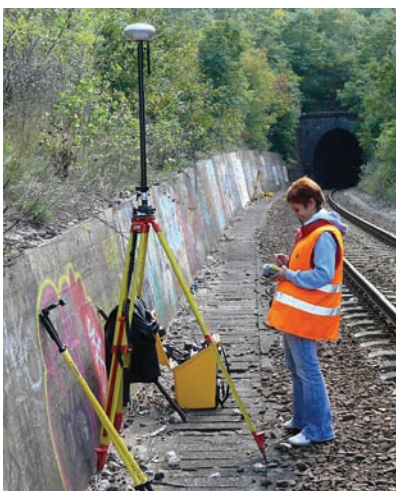
1. ábra. Bázis (referencia)-állomásként használt Topcon GNSS vevő
