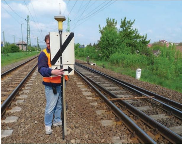
8. ábra. Sebességkorlátozó tábla felmérése Szob állomáson
