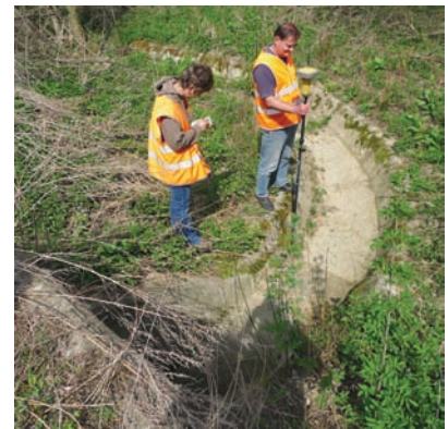
2. ábra. Vízvezető árok mérése a mozgó vevővel
