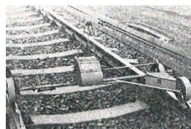
1. ábra. A Vámos–Kapoly vágánymérő készülék korabeli fotója
