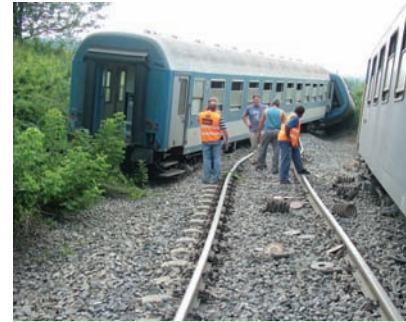
13. ábra. A kereszttirányban szétcsúszott utolsó három kocsi
