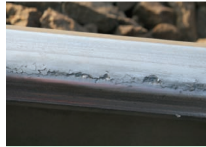
23. ábra. Folyamatos kitöredezés a futóélen (kíhasadás)
