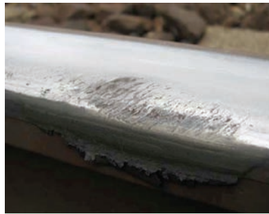
13. ábra. A sötét foltok alatt a sínfejrepedések már összenöttek
