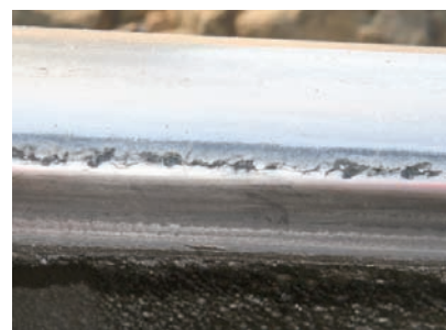
24. ábra. A kipattogzások sokasága folyamatos kitöredezettséget alkot
