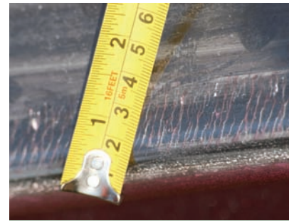
14. ábra. A sínfejrepedések hossza meghaladja a 20 millimétert
