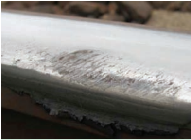
21. ábra. A sötét foltok alatt a Head Checking repedések már összenőttek
