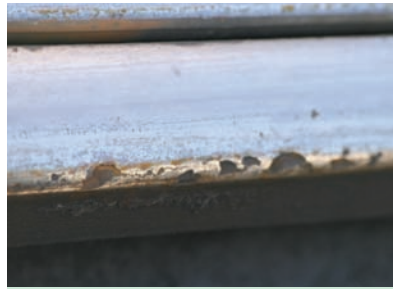
22. ábra. Lokális kitöredezések a futóélen
