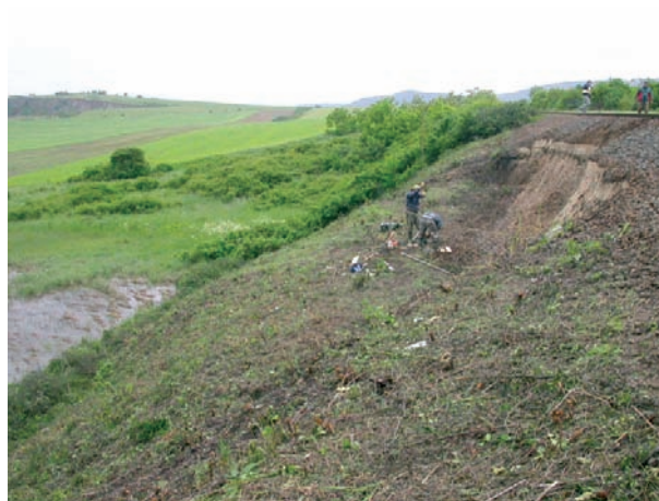
4. ábra. Talajmintavétel a töltéscsúszás helyén
