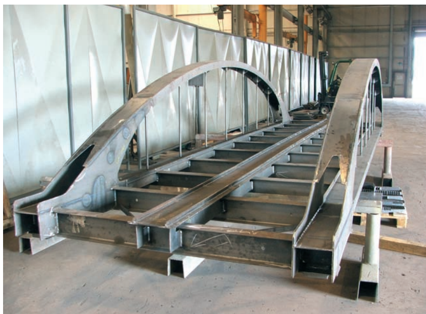
7. ábra. Áthidaló szerkezet a gyártás befejező fázisában
