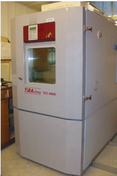
6. ábra. Klímaberendezés az időállósági vizsgálatokhoz
