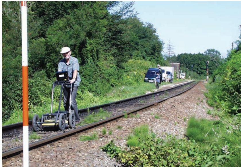
1. ábra. Töltésvizsgálat vasúti vágánytengelyben, NOGIN–250 típusú berendezéssel
