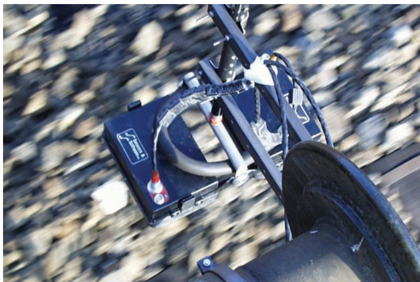
11. ábra. Vasúti gép ütközőjére szerelt antennák az aljvégek felett, mérés közben
