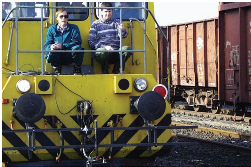
10. ábra. Töltésvizsgálat vágánytengelyben, gépre szerelt antennákkal
