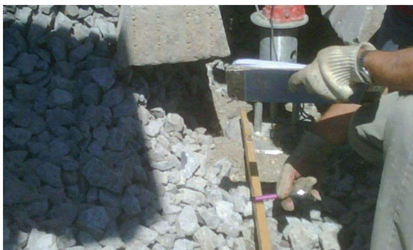
6. kép. Alépítmény teherbírás-vizsgálata
