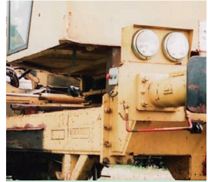
10. ábra. Ágyazatrendező munka közben
