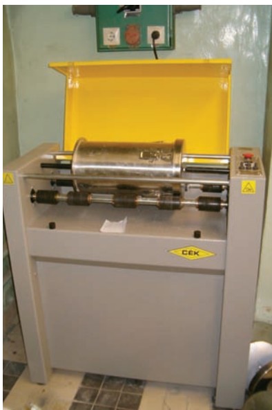
5. ábra. Mikro-Deval berendezés a vasúti ágyazati anyagok vizsgálatára szolgáló 400 mm hosszú dobbal
