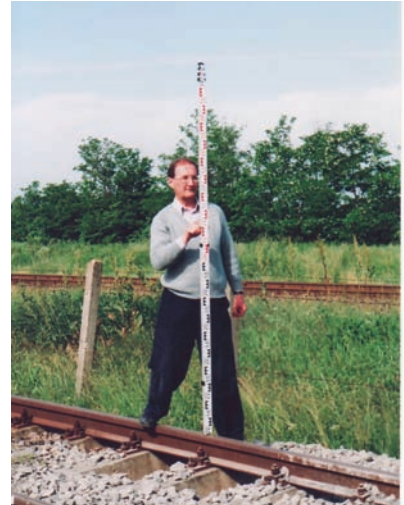
14. ábra. A kísérleti pálya geodéziai bemérése
