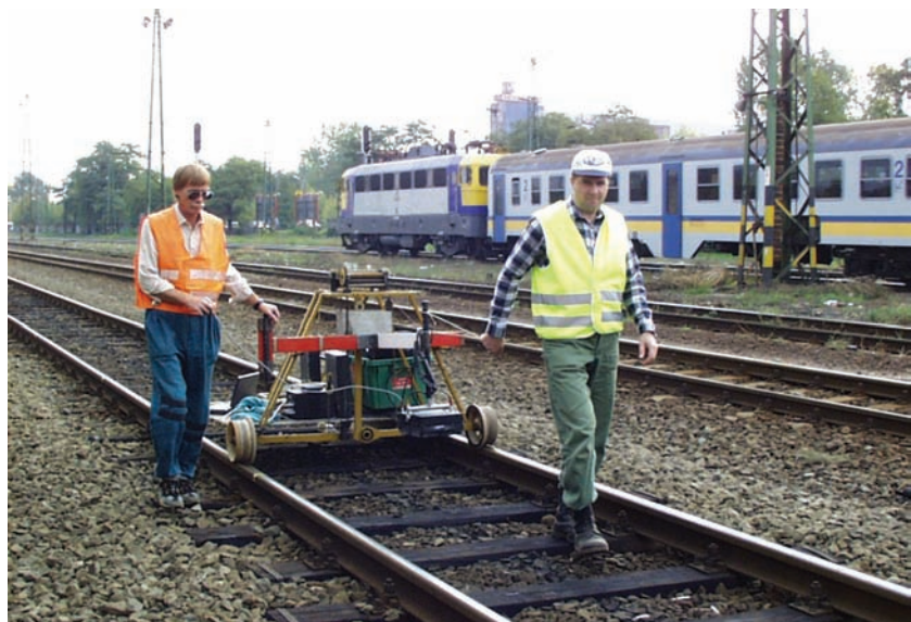
2. ábra. Töltésvizsgálat aljvégeken, pillekocsira szerelt antennákkal, pulseEKKO–1000 típusú berendezéssel
