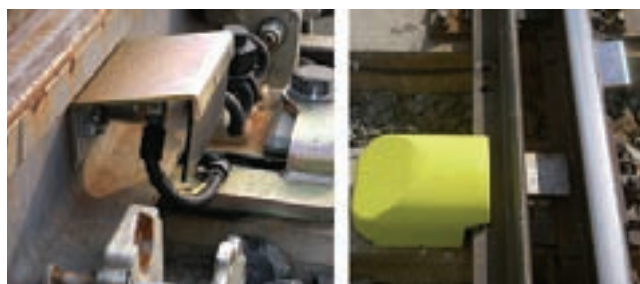
6. ábra. A csúcspín pozícióját ellenőrző induktív adók
