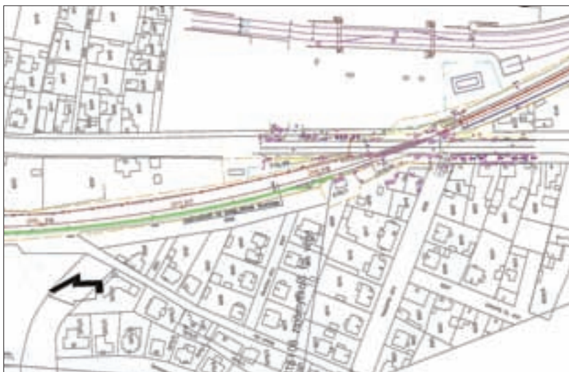
2. ábra. Zajvédő fal kiviteli terve (helyszínrajz) Forrás: MÁVTI Kft.
