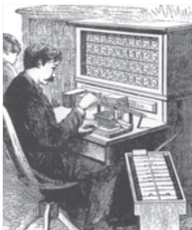
2. ábra. Népszámlálási adatok kiértékelése az Egyesült Államokban 1890-ben, lyukkártyák segítségével
