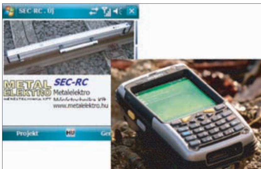
6. ábra. Az egyenességmérő gerenda és a PDA Bluetooth-kapcsolaton keresztül kommunikál egymással
