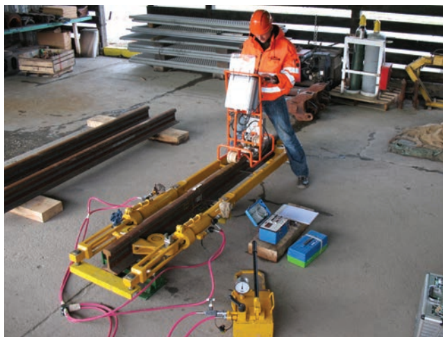
4. ábra. Kalibrálás feszítőművel sínmintán az Egyesült Államokban
