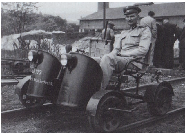
6. ábra. Csővázás könnyű vágánygépkocsi
