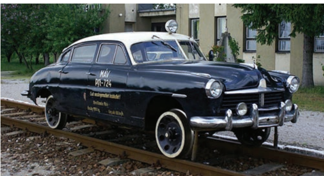
14. ábra. Hudson Commadore- ból 1967-ben átalakított sínautó
