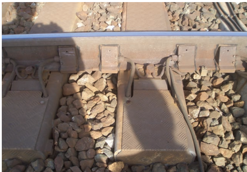
4. ábra. A kerékteher mérése speciális aljakon
