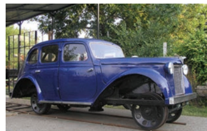
15. ábra. 1930-ban gyártott Austin személygépkocsi keskeny nyomtávú sínautóvá alakítva
