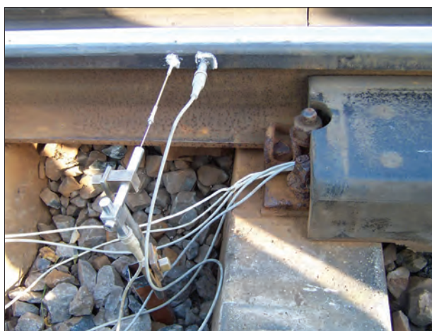
4. ábra. A sínfej keresztirányú elmozdulásának és gyorsulásának érzékelője
