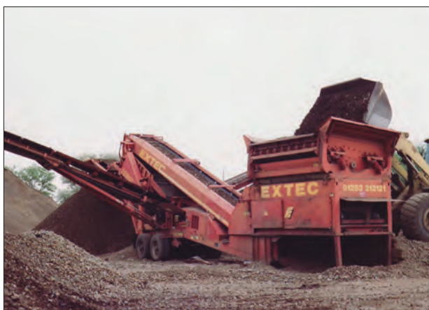
10. ábra. EXTEC mobil rostálás gépei Gyoma állomáson
