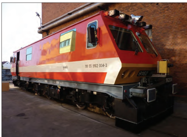
1. ábra. Űrszelvénytérő az FMK-004 felépítményi mérőkocsin
